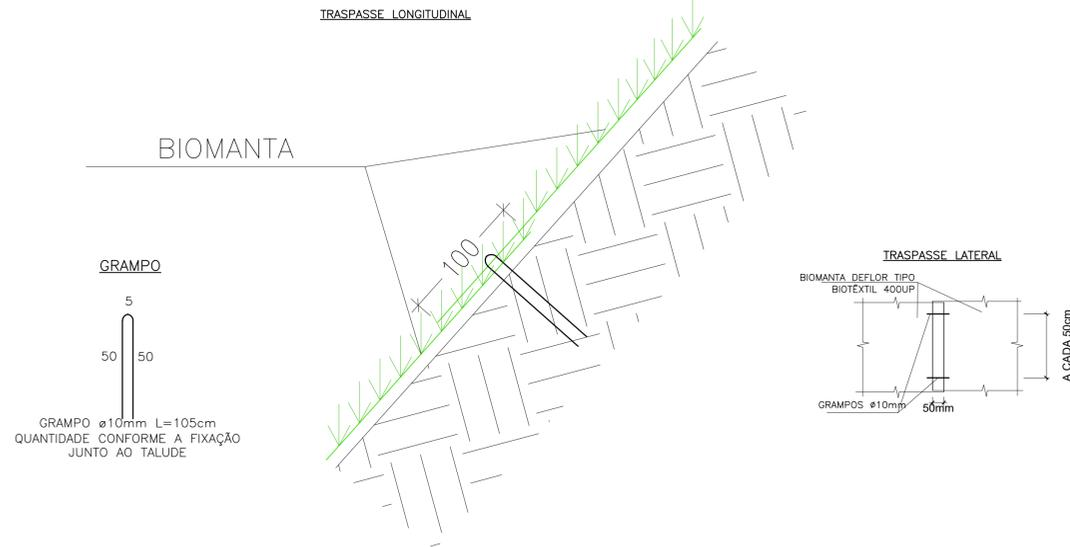
SEÇÃO ESQUEMÁTICA - CANALETA COM/SEM DEGRAUS E REVESTIMENTO COM BIOMANTA (INT. 10)
