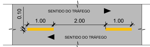
DETALHE 15 - LINHA DE DIVISÃO DE FLUXOS OPOSTOS - LINHA SIMPLES SECCIONADA (LFO-2) (PARA CICLOVIAS) TINTA: TERMOPLÁSTICA (EXTRUSÃO) COR: BRANCA ESC.: 1/75
