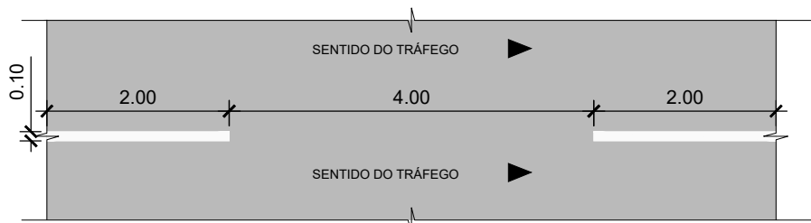
DETALHE 10 - LINHA DE DIVISÃO DE FLUXOS DE MESMO SENTIDO - LINHA SIMPLES SECCIONADA (LMS-2) TINTA: TERMOPLÁSTICA (EXTRUSÃO) COR: BRANCA ESC.: 1/75
