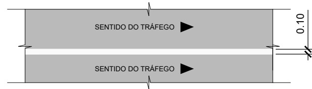
DETALHE 09 - LINHA DE DIVISÃO DE FLUXOS DE MESMO SENTIDO - LINHA SIMPLES CONTÍNUA (LMS-1) TINTA: TERMOPLÁSTICA (EXTRUSÃO) COR: BRANCA ESC.: 1/75
