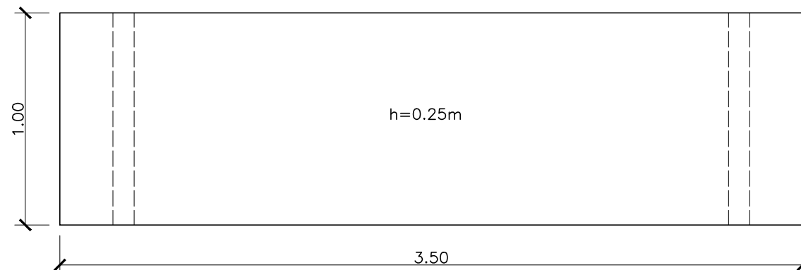
01 PLANTA DE FORMA DA ADUELA ESC: 1/25
