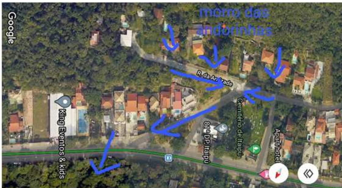
Foto 36 : Detalhe do escoamento das águas do morro das andorinhas pelas Ruas da Amizade e Ralph de Andrade até chegar a Est. Francisco da Cruz Nunes e desaguar na região de mangue do entorno da lagoa de Itaipu.
