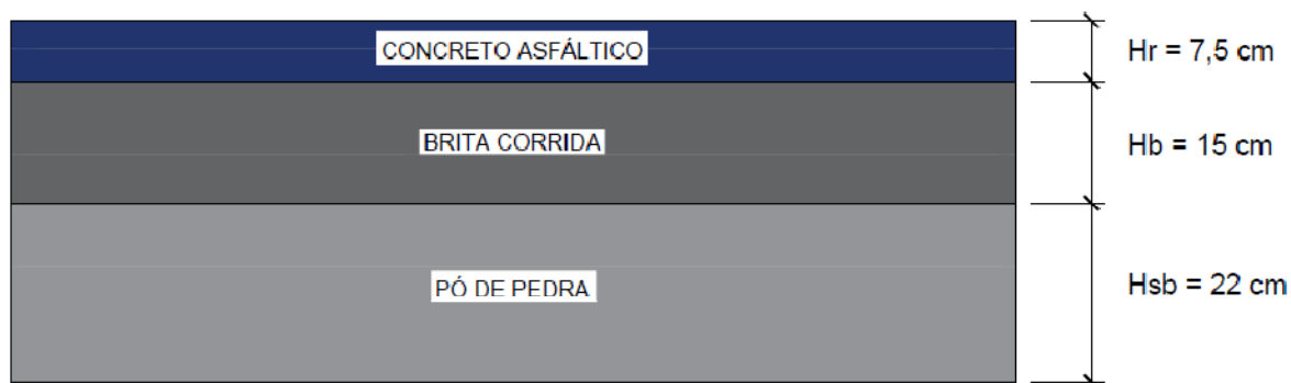
Figura 4 – Estrutura do pavimento projetado para Via Principal
