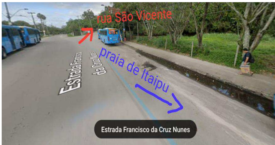
Foto 9 : Acúmulo de água junto ao meio fio ao longo do local de parada dos ônibus. Este problema se deve a falta de caixas ralo e a insuficiência do sistema de drenagem que nesse ponto só conta com uma pequena rede de 300mm sob a sarjeta que interliga as caixas ralo
