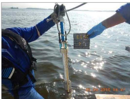
Figura 9-4. Preparação para amostragem com Gravity Corer.
