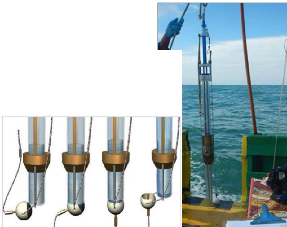
Figura 9-2. Amostrador de sedimento tipo Gravity corer.
