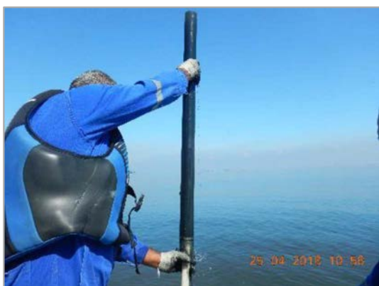
Figura 9-5. Amostragem com Gravity corer.
