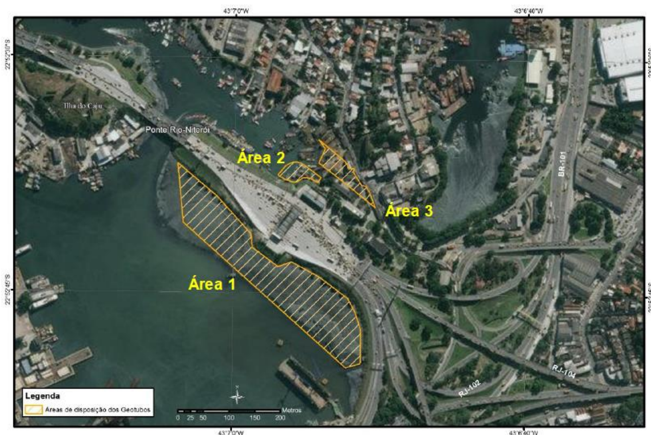
Figura 2.1: Localização das áreas para disposição dos geotubos (disposição confinada do material com concentrações de substâncias acima do nível 2 ou com efeito tóxico significativo, de acordo com a Resolução CONAMA nº 454/12).
