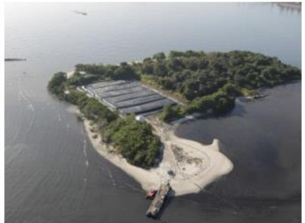
Figura 2.5.1.2: Encapsulamento do material dragado na Ilha da Pombeba durante a dragagem do Porto do Rio de Janeiro.
