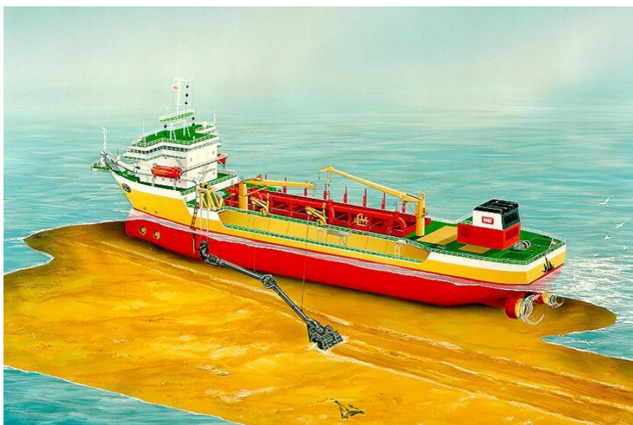
Figura 2.3.2.1: Ilustração de uma draga autotransportadora com um braço de dragagem.
