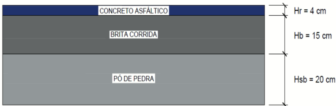
Figura 3 – Estrutura do pavimento projetado
