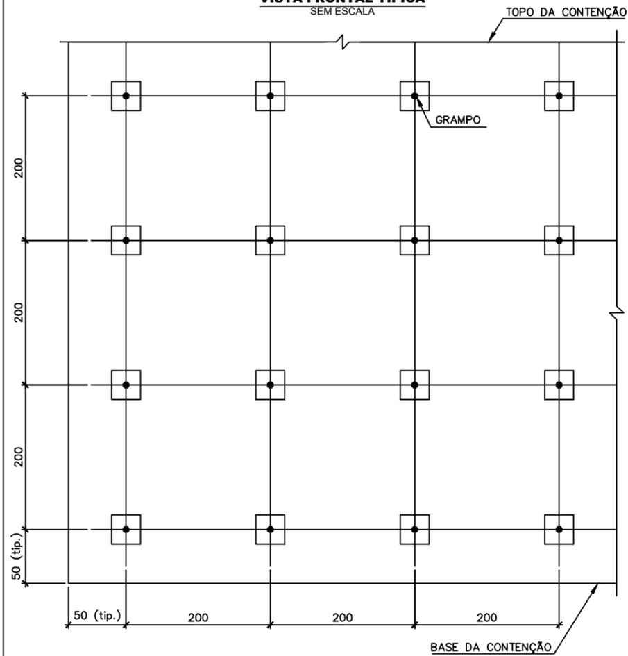
**DETALHE 1 - GRAMPO E FACE REVESTIDA COM GEOMANTA**
