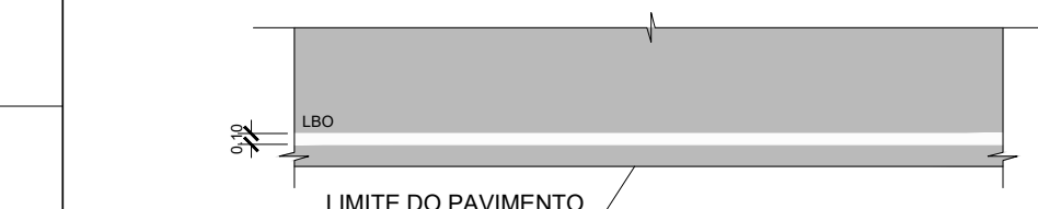
DETALHE 07 - LINHA DE BORDO (LBO) TINTA: TERMOPLÁSTICA (EXTRUSÃO) COR: BRANCA / VERMELHA ESC: 1/75
