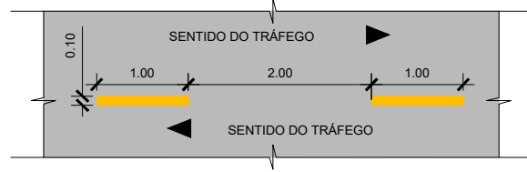
DETALHE 12 - LINHA DE DIVISÃO DE FLUXOS OPOSTOS - LINHA SIMPLES SECCIONADA (LFO-2) (PARA CICLOVIAS) TINTA: TERMOPLÁSTICA (EXTRUSÃO) COR: AMARELA ESC: 1/75
