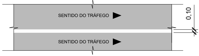
DETALHE 08 - LINHA DE DIVISÃO DE FLUXOS DE MESMO SENTIDO - LINHA SIMPLES CONTÍNUA (LMS-1) TINTA TERMOPLÁSTICA (EXTRUSÃO) COR: BRANCA ESC. 1/75
