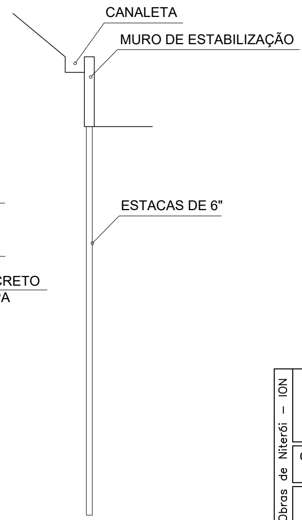
3 CORTE - SOLO GRAMPEADO DE MONTANTE ESC.: 1/100
