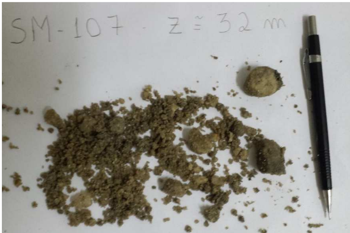
Figura A3.9 – Sondagem SM-107 – Detalhe de pedregulhos a cerca de 32 m de profundidade
