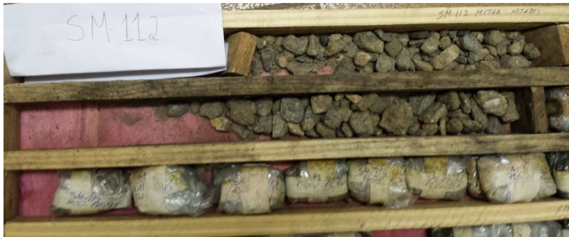
Figura A3.11 – Sondagem SM-112 – Detalhe de cascalhos a pequena profundidade
