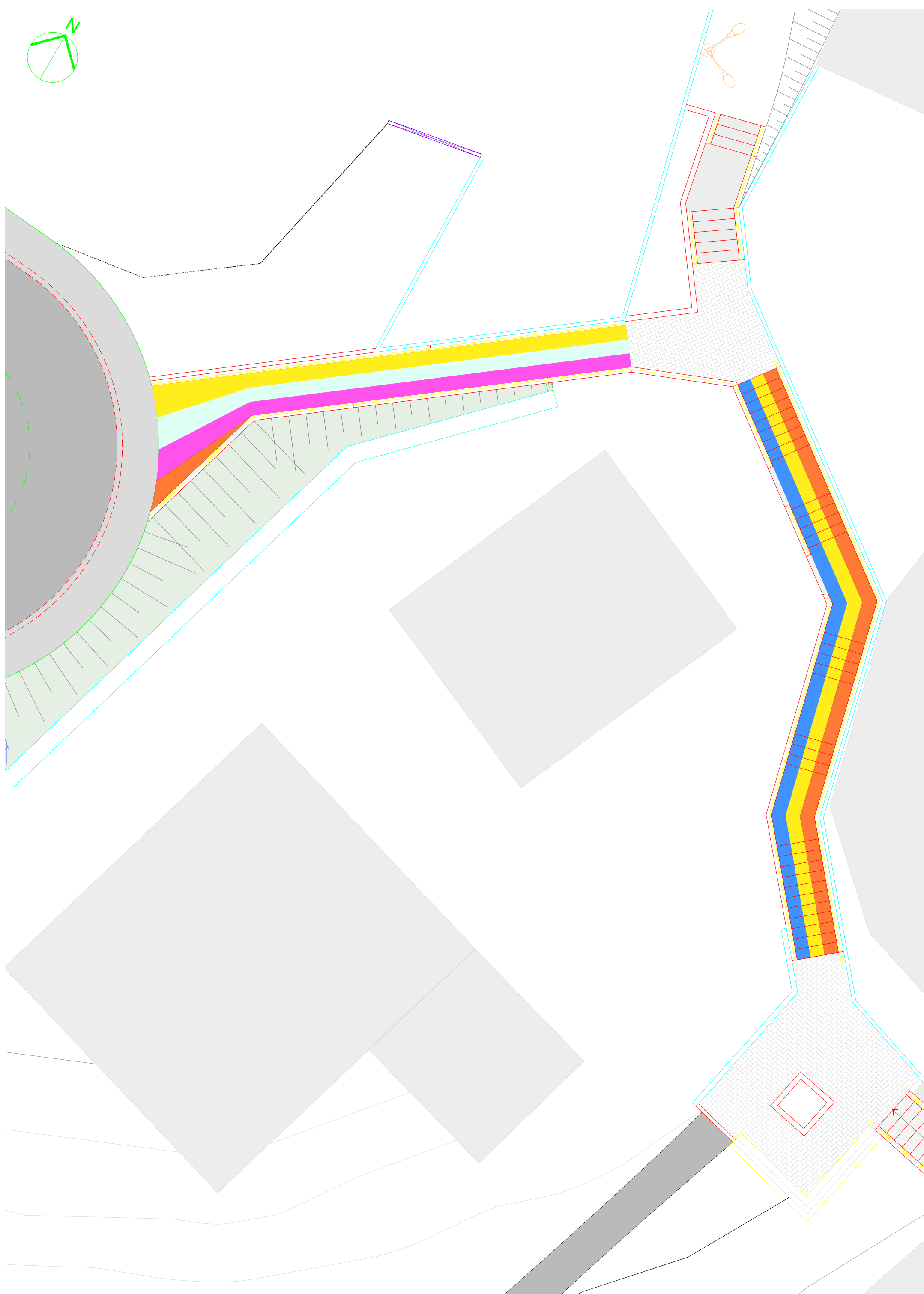
03 ESCADARIA 01 - TRECHO 03 - PINTURA DO PISO ESC. 1/100
